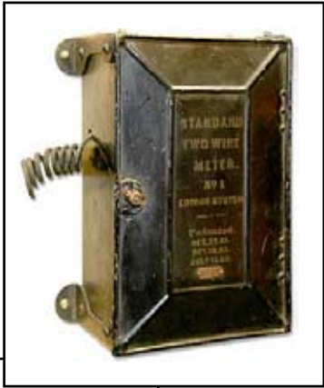
Grosser Kasten mit wenig Inhalt: Edison's «Chemical Meter», oben der zickzackförmig plazierte «Shunt», unten das kleine Gefäss mit den beiden Elektroden
